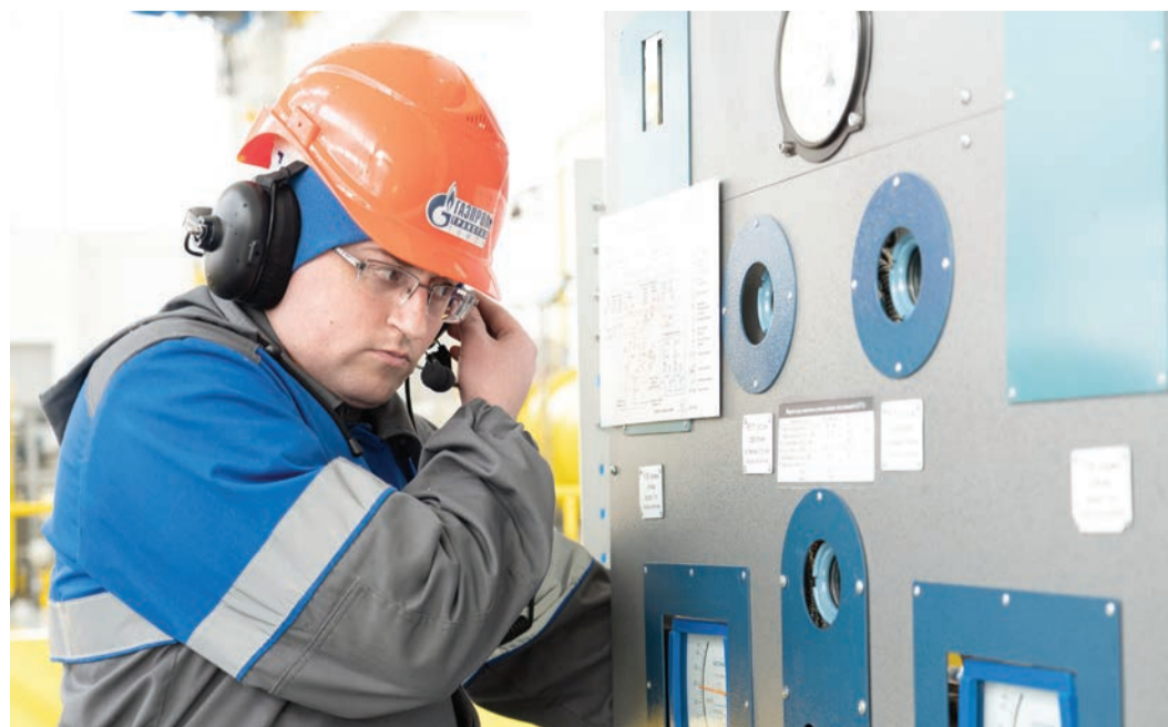
Вибродиагностика позволяет определить состояние ГПА и то, насколько качественно проводилось его техническое обслуживание
